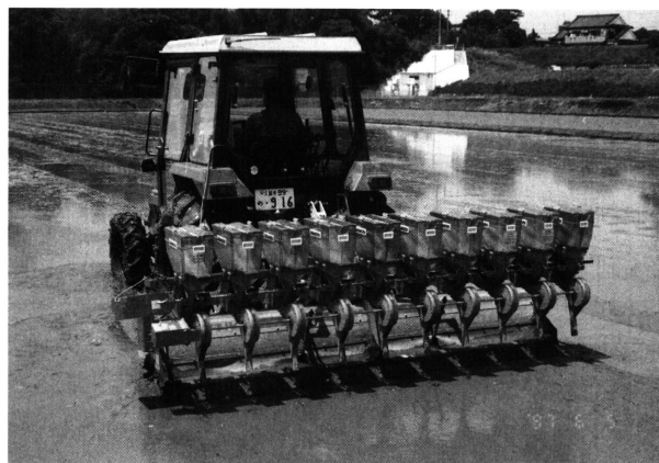
写真 1. ショットガン直播機による播種状況 (福岡県朝倉郡夜須町)
